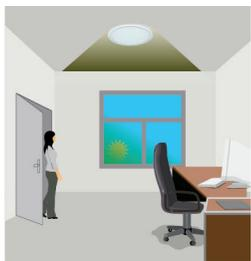
Le luminaire s'allume automatiquement avec présence lorsque la lumière naturelle est insuffisante.
