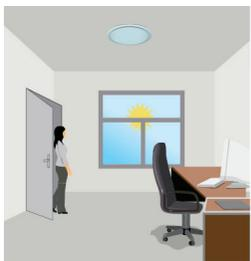
Le luminaire ne s'allume pas lorsque la lumière naturelle est suffisante, même si un mouvement est détecté.
