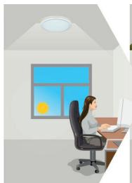
La lumière s'allume à pleine puissance ou diminue pour maintenir le niveau de lux. La puissance lumineuse se règle en fonction du niveau de la lumière naturelle disponible.
